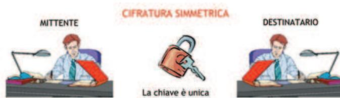
Figura 3.6: Schema relativo alla crittografia simmetrica
